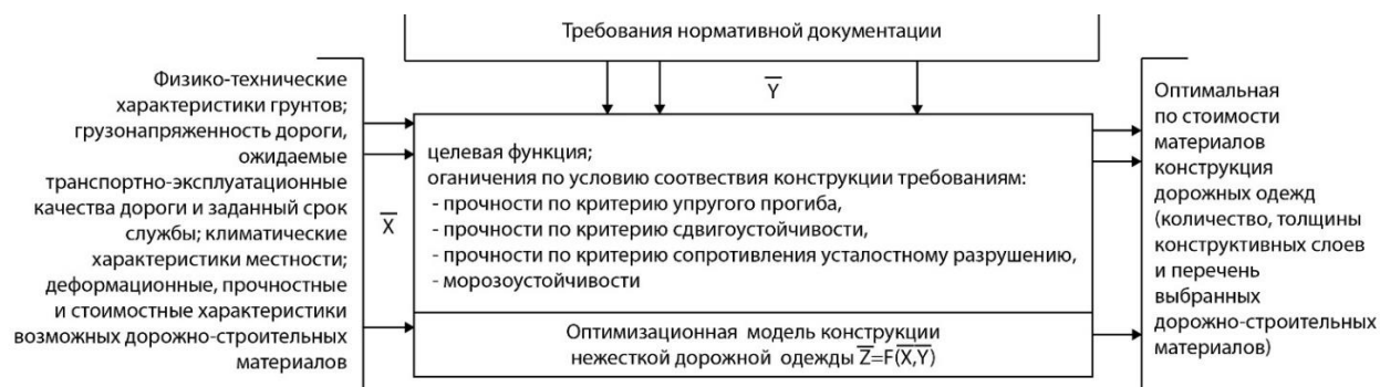
Рисунок 2.5 – Концептуальная модель расчета конструкции нежестких дорожных одежд
