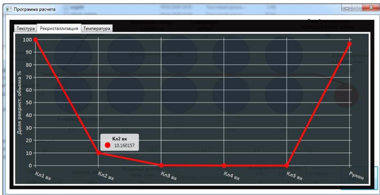
Рисунок 3.5 – Пример диаграммы расчетной доли рекристаллизованного объема
