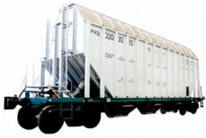
Рисунок 5.12 – Новый железнодорожный вагон-хоппер модели 19-1244 с использованием сплава 1565ч, произведённого по указанной выше технологии
