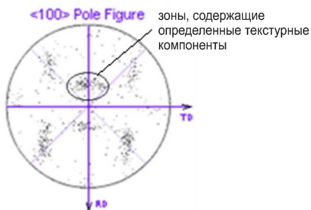
Рисунок 1.10 – Принцип определения текстурных компонент на полюсной фигуре [13]
