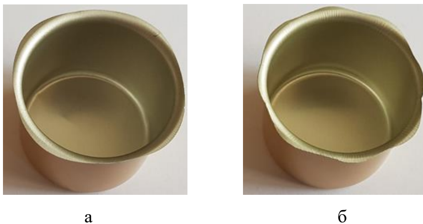
Рисунок 5.8 – Фестонистость в сплаве 8011
