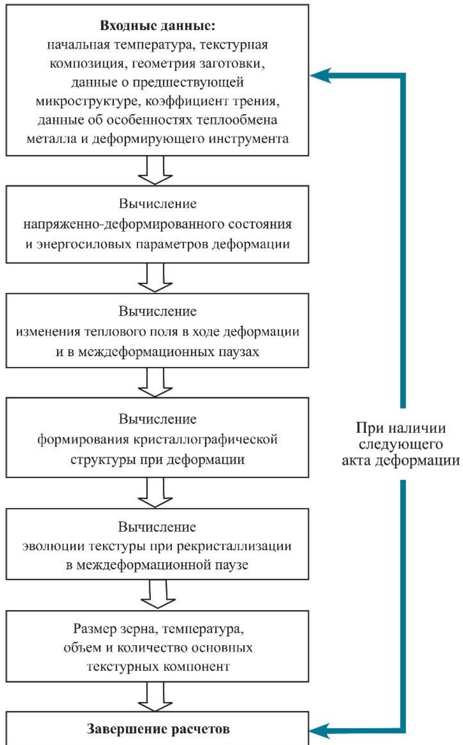
Рисунок 3.1 – Принципиальная схема модели расчета кристаллографической структуры в непрерывном стане
