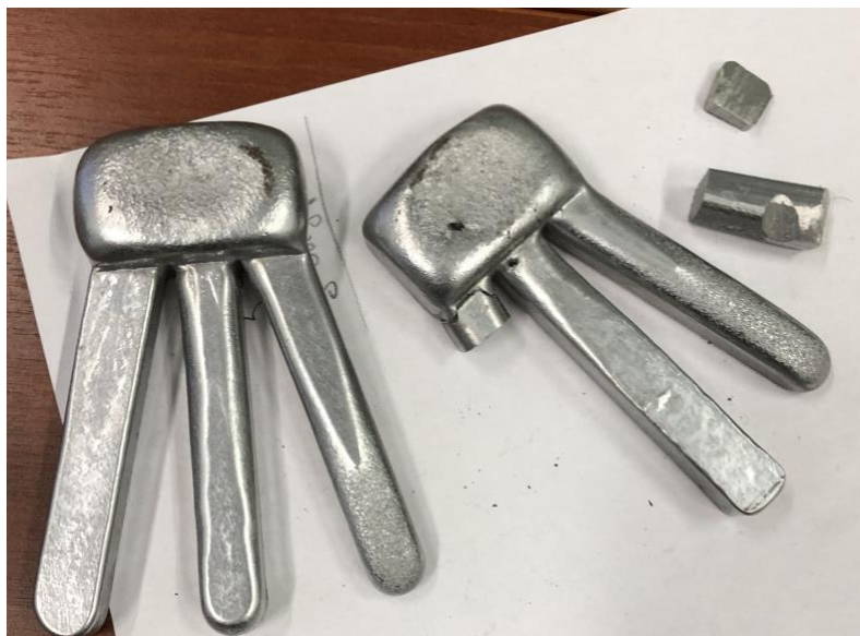
Рисунок 2.6 – Полученные отливки для проведения испытаний
