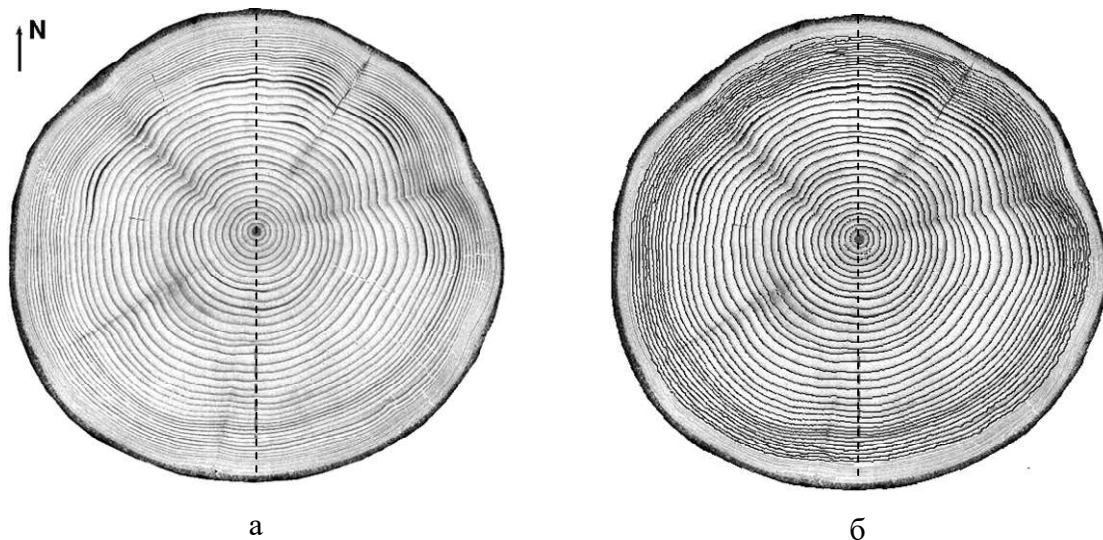
а – поперечное сечение ствола ели в градациях серого цвета, б – контуры границ годичных слоев, выделенные алгоритмом распознавания колец, наложенные на исходное изображение поперечного сечения ствола ели
