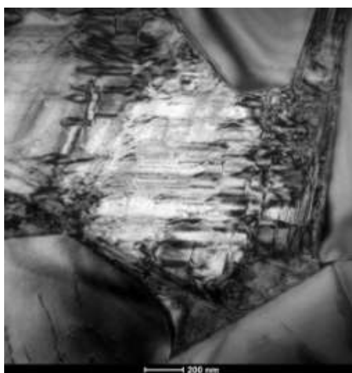
Рисунок 5.29 – Структура сплава ВК10КС после электровзрывной обработки титаном на расстоянии 20 мкм от поверхности
