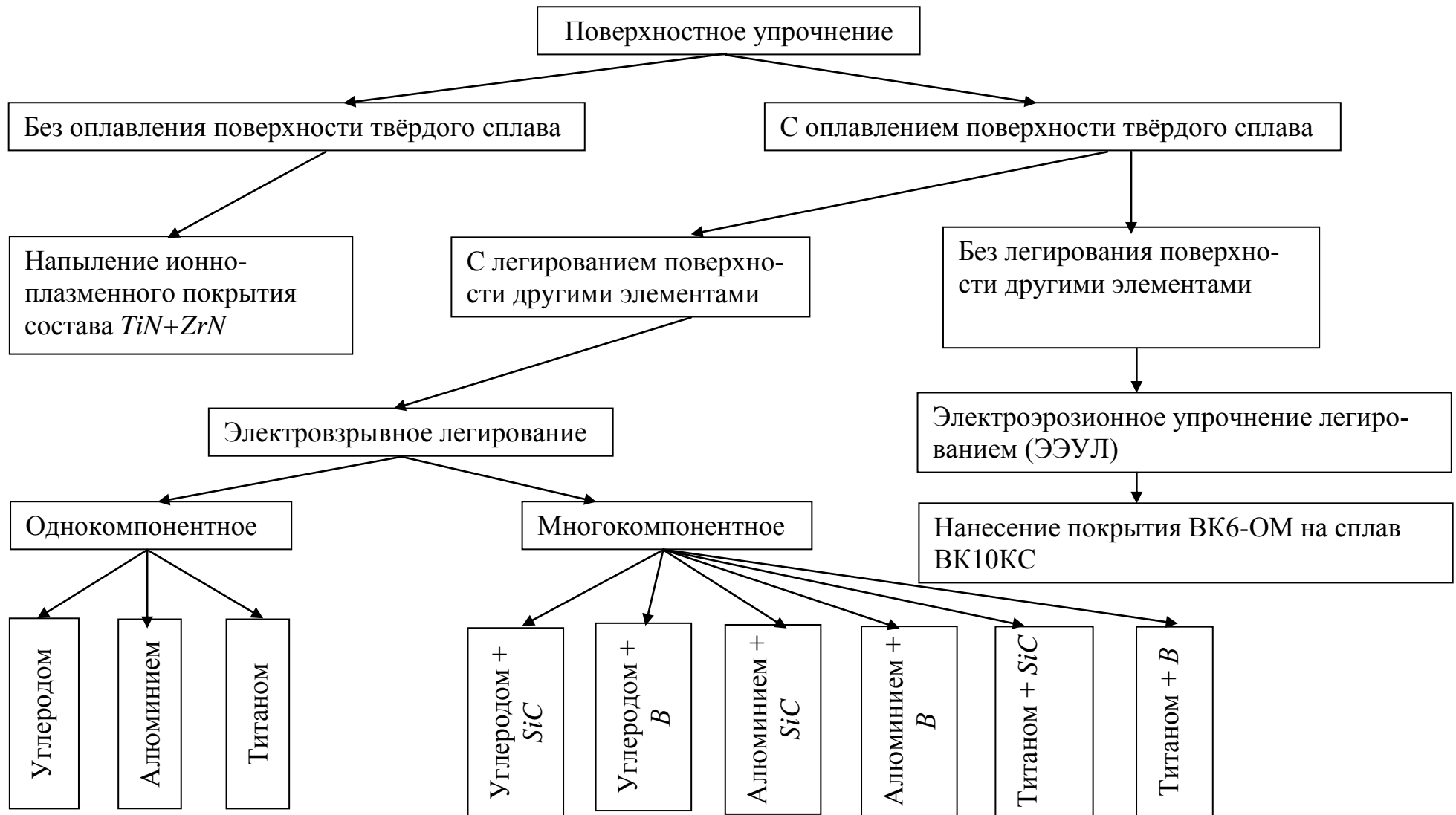
Рисунок 2.3 – Классификация упрочняющих поверхностных обработок для WC-Co твёрдых сплавов, используемых в диссертационной работе
