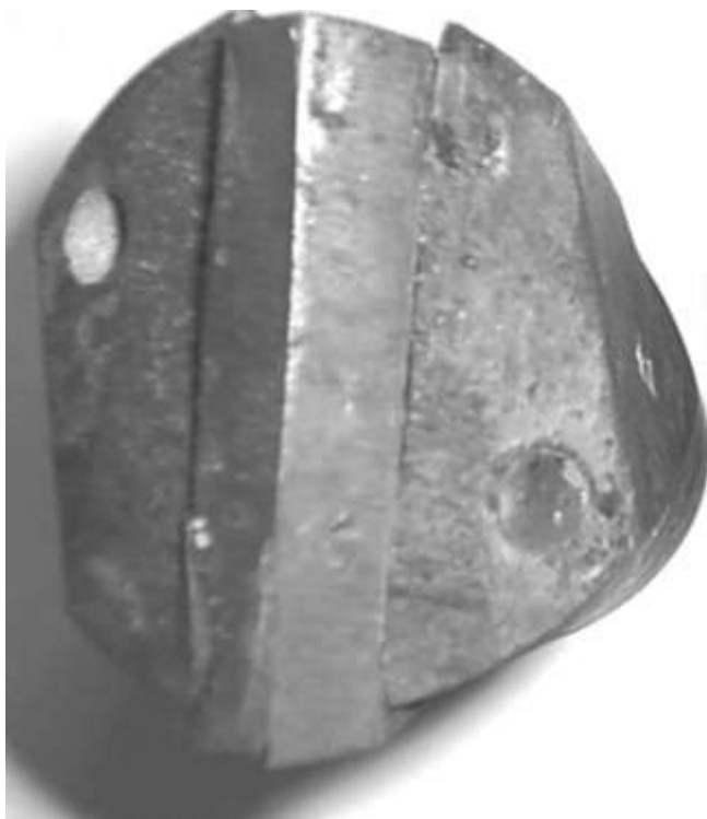
Рисунок 2.1 – Внешний вид буровой коронки после эксплуатации
