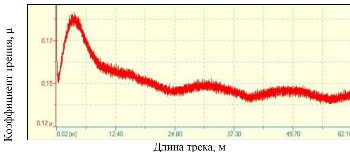
Рисунок 5.34 – Фрагмент интерфейса программы для определения коэффициента трения ( \mu ) сплава ВК10КС после обработки электровзрывом титана в высокоэнергетическом режиме
