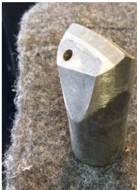
Рисунок 1.1 – Долотчатая коронка для перфораторного бурения
