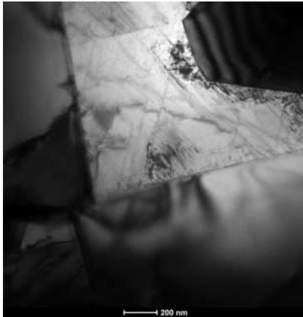
Рисунок 5.3 – Структура сплава ВК10КС после электровзрывной обработки углеродом по низкоэнергетическому режиму на расстоянии 10 мкм от поверхности
