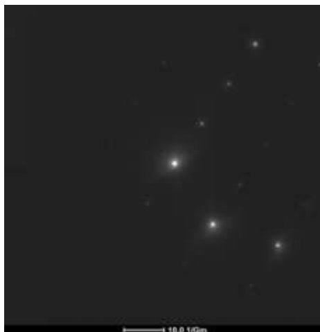
Рисунок 6.5 – Электроннограмма от участка кристалла карбида дивольфрама в кобальтовой связующей; ориентировка [103]
