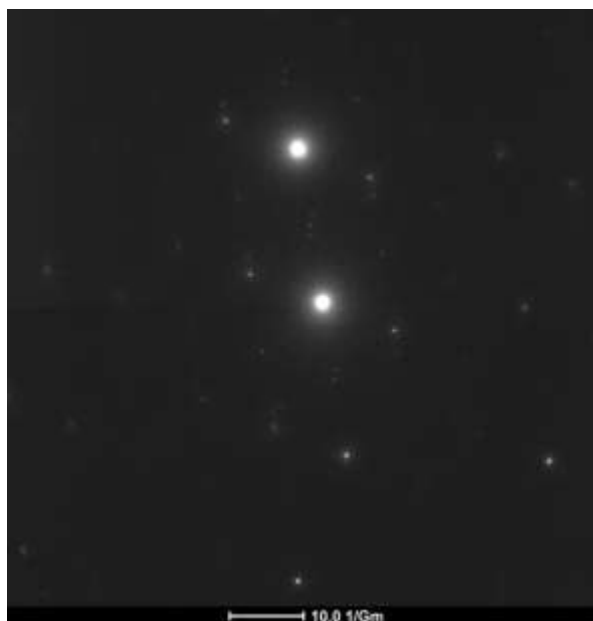
Рисунок 5.31 – Электроннограмма от участка кристалла карбида дивольфрама в кобальтовой связующей; ориентировка [101]
