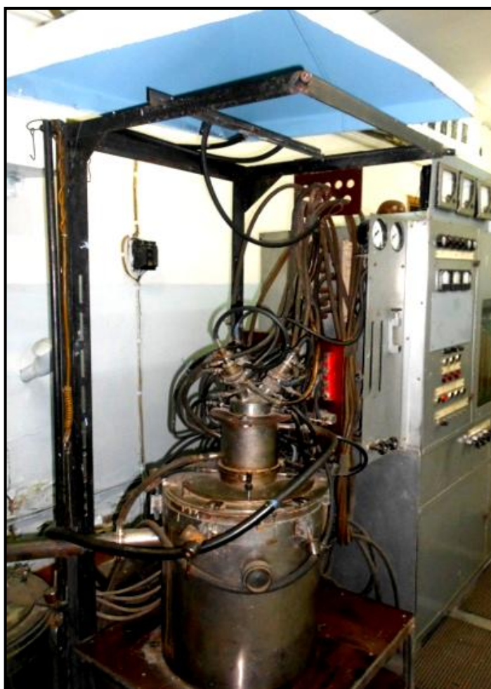
Рисунок 3.1 – Плазмометаллургический реактор
