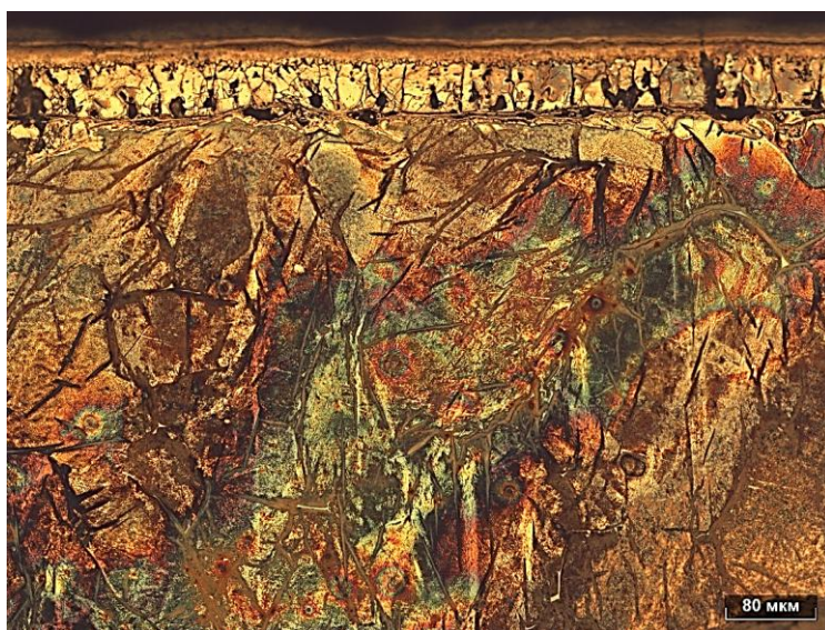
Рисунок 9 – Микроструктура образца титана VT1-0 после диффузионного насыщения из смесей, содержащих бор, хром и титан
