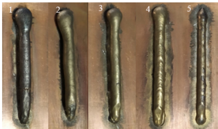
Рисунок 2.17 – Швы, сформированные на разных скоростях движения сварочной горелки холодного переноса металла
