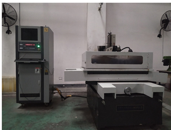
Рисунок 2.3 – Обработка на электроэрозионном вырезном станке
