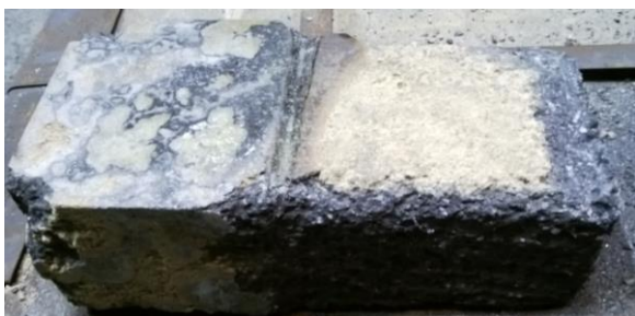
Рисунок 9 – Характерный внешний вид алюмопериклазоуглеродистых огнеупоров после разогрева по действующим режимам (левая половина защищена покрытием)
