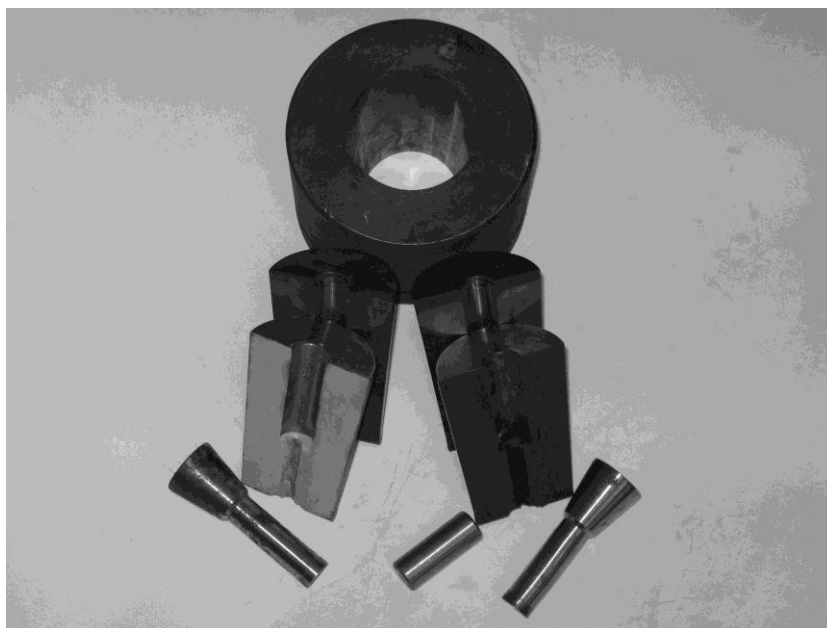
Рисунок 3.24 – Детали штампа для закрытого выдавливания
