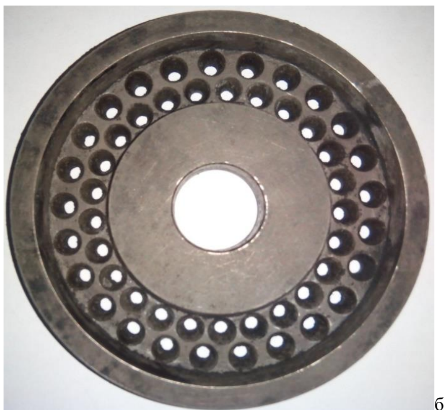
Рисунок 5.3 Изображение фильеры гранулятора по выпуску катализатора ПАО «НЗХК» из стали 7ХГ2ВМФ, а) – до упрочнения, б) – после упрочнения
