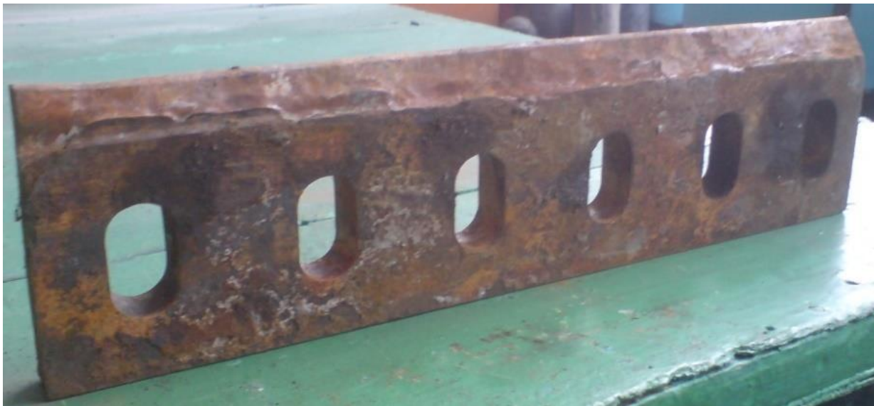
Рисунок 5.1 Нож из стали Ст3 для измельчения полипропиленовых корпусов АКБ, а) – в насыщающей обмазке до помещения в печь, б) – упрочненный нож до снятия насыщающей обмазки, в) – нож после выработки 160 – 180 т измельченных корпусов АКБ
