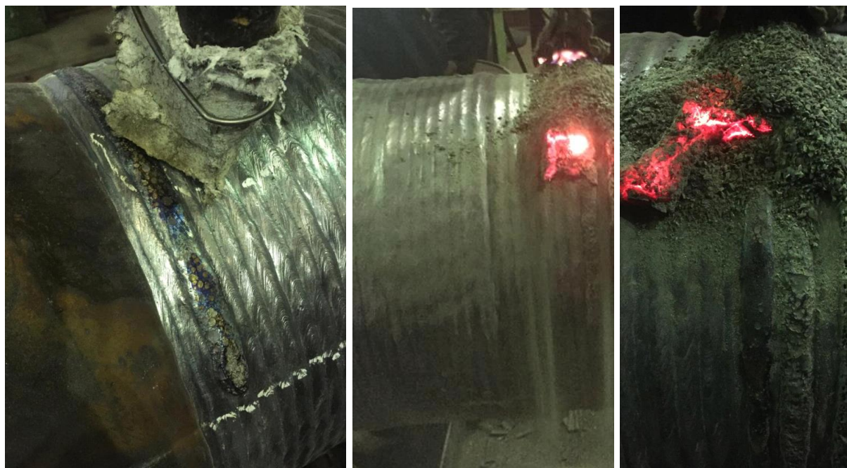
Рисунок 5.8 – Ремонтно-восстановительные работы прокатных валков с использованием экспериментальных порошковых проволок
