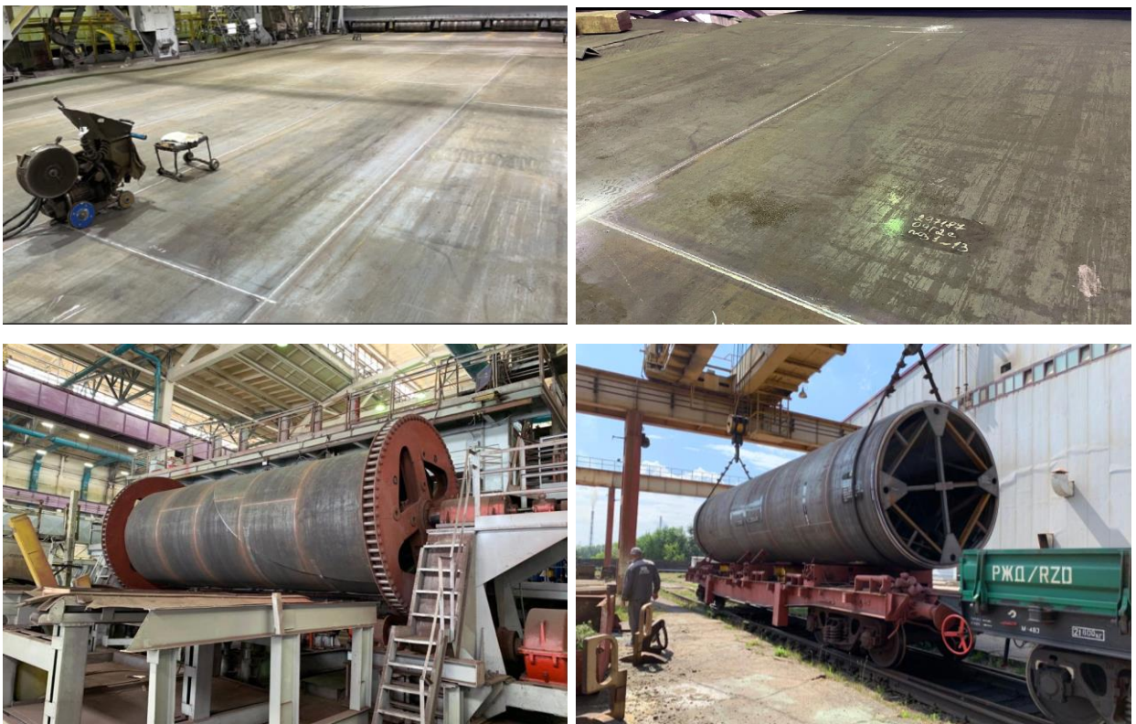
Рисунок 5.6 – Различные этапы производства сварной металлоконструкции по разработанной технологии
