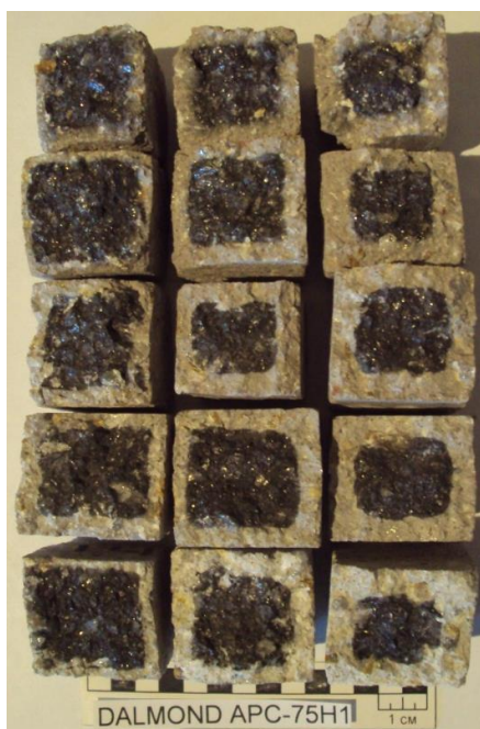
Рисунок 3.1 – Внешний вид алюмопериклазоуглеродистых огнеупоров после тепловой обработки (горизонтальные ряды слева на право время выдержки 1, 2 и 3 ч, вертикальные ряды сверху вниз температура выдержки 900, 1000, 1100, 1200, 1250 °С)
