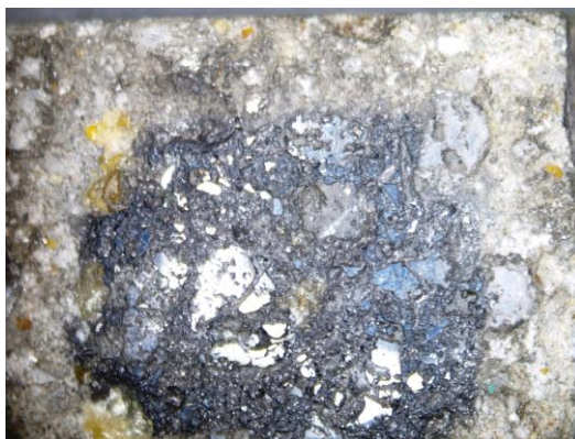
Рисунок – 3.5 Макроструктура обезуглероженных слоев огнеупора (увеличение \times 6 )
