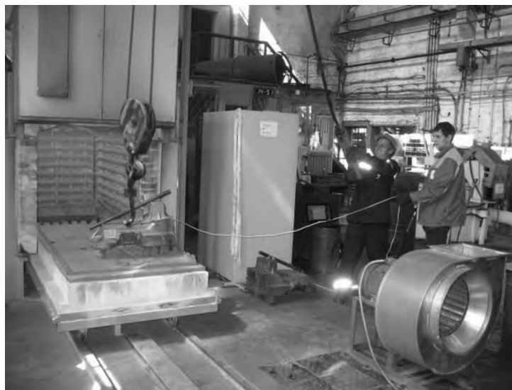
Рисунок 4.15 –Термообработка фрагмента отливки «Балка надрессорная» на предприятии ООО «Алтайский сталелитейный завод»
