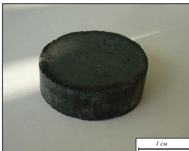
Рисунок 4.1 – Брикет из МК-ФС и БПК
