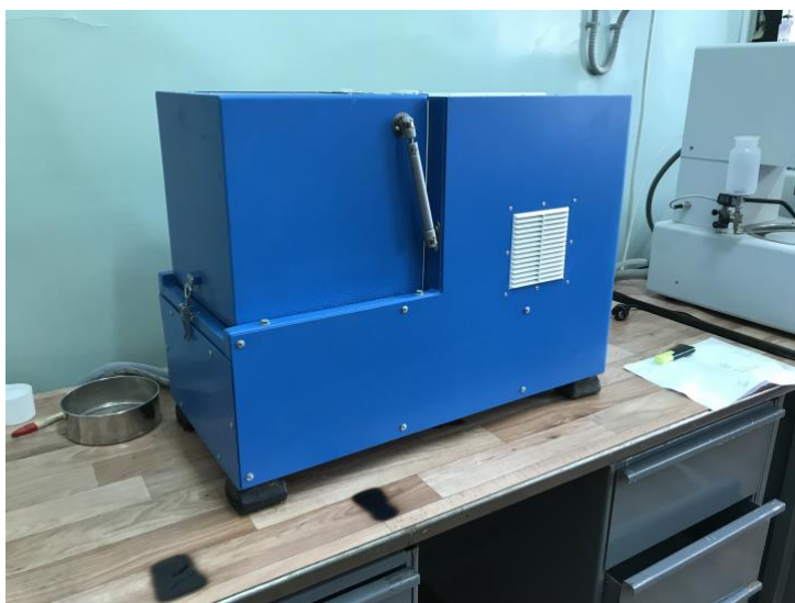
Рисунок 2.3 – Планетарно шаровая мельница «Активатор-2SL»
