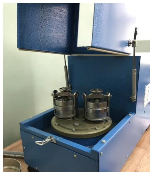
Рисунок 2.3 – Планетарно шаровая мельница «Активатор-2SL»
