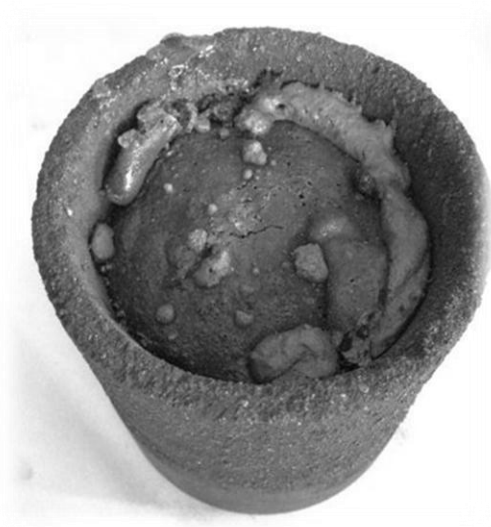
Рисунок 4.11 – Тигель со сталью после охлаждения
