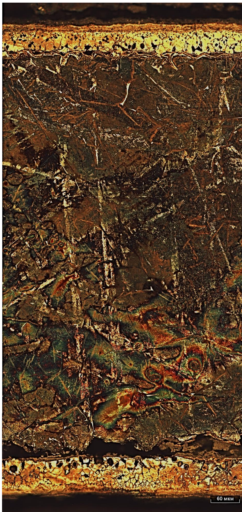
Рисунок 5.61 – Микроструктура образца, расположенного на расстоянии 10 мм от поверхности насыщающей среды
