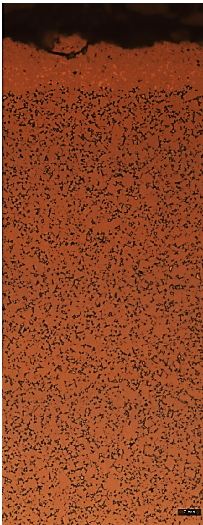
Рисунок 5.66 – Микроструктура диффузионного покрытия на спеченном материале ВК8
