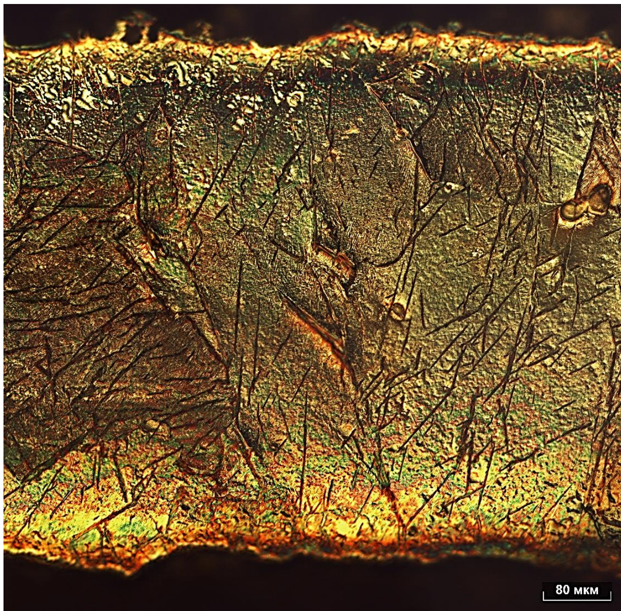
Рисунок 5.59 – Микроструктура образца, расположенного на расстоянии 50 мм от поверхности насыщающей среды
