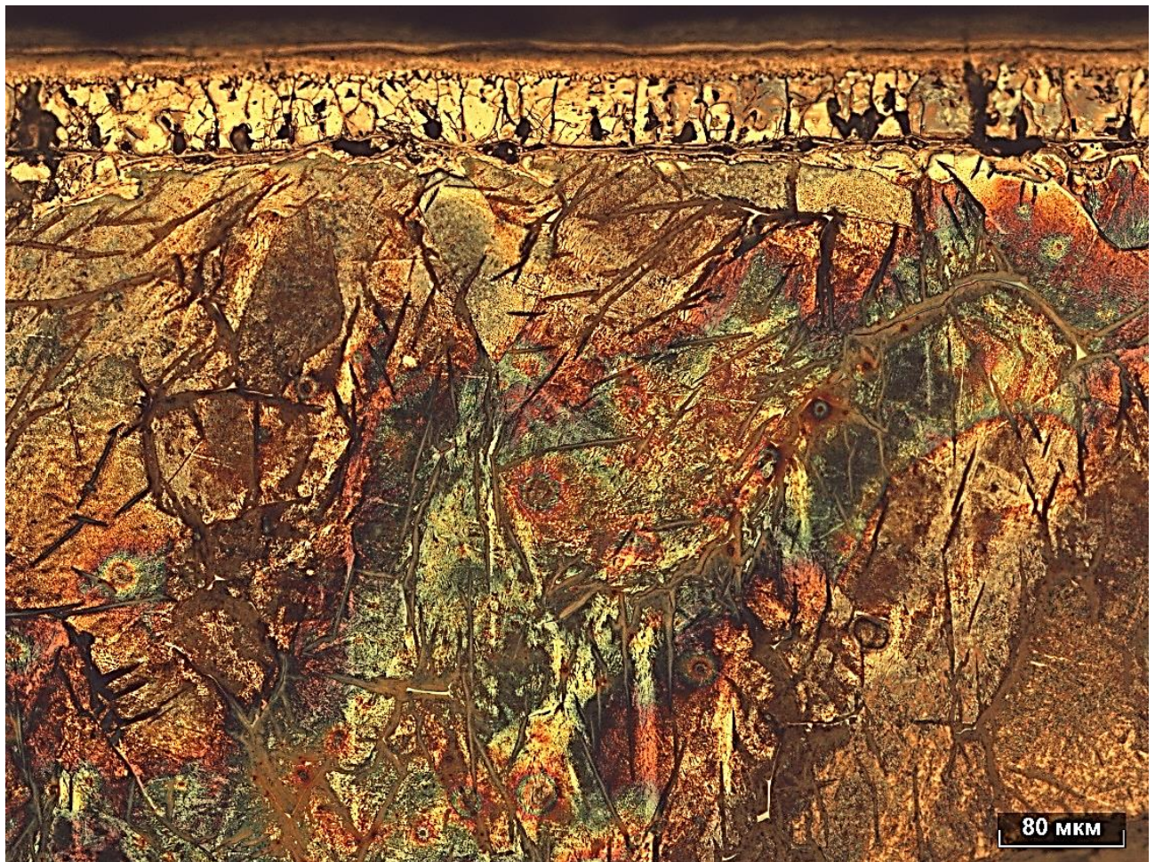
Рисунок 5.60 – Микроструктура образца, расположенного на расстоянии 25 мм от поверхности насыщающей среды
