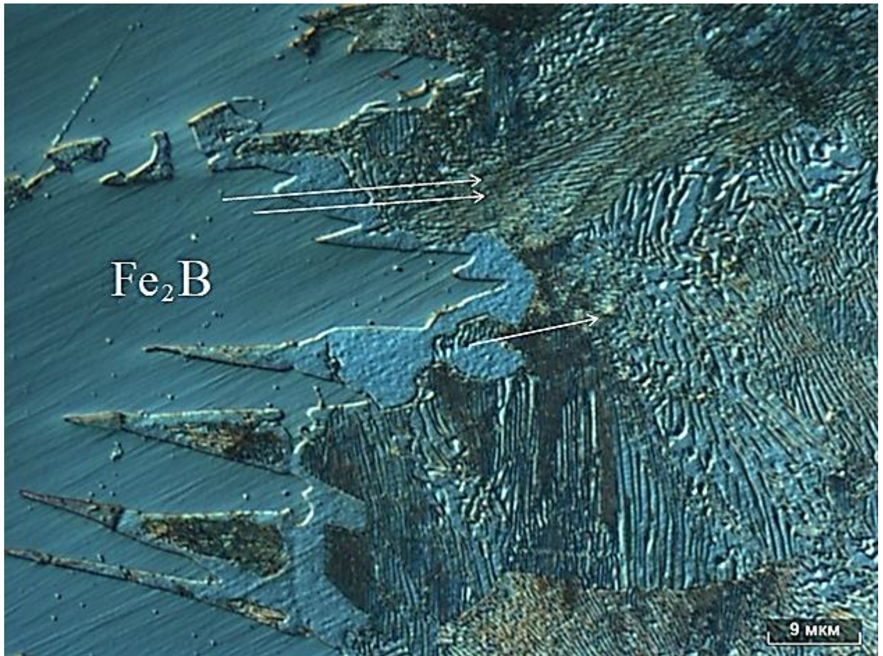
Рисунок 5.11 – Микроструктура границы слоя боридов и переходной зоны на стали Ст3 после диффузионного бор–хром–титанирования. Одиночной стрелкой показан первоначальный перлит, двойной стрелкой показан перлит, образовавшийся в результате диффузии атомов углерода, бора и хрома вглубь материала
