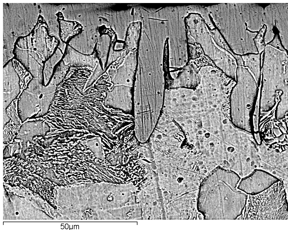
Рисунок 5.48 – Микроструктура диффузионного покрытия на стали 5ХНМВФ, полученное одновременным насыщением бором, хромом и титаном
