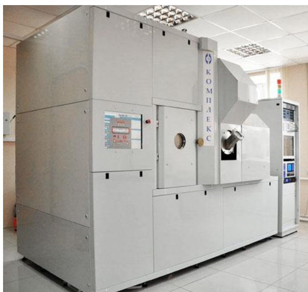
Рисунок 2.3 – Общий вид установки «КОМПЛЕКС» для импульсной поверхностной модификации материалов электронным пучком и азотирования
