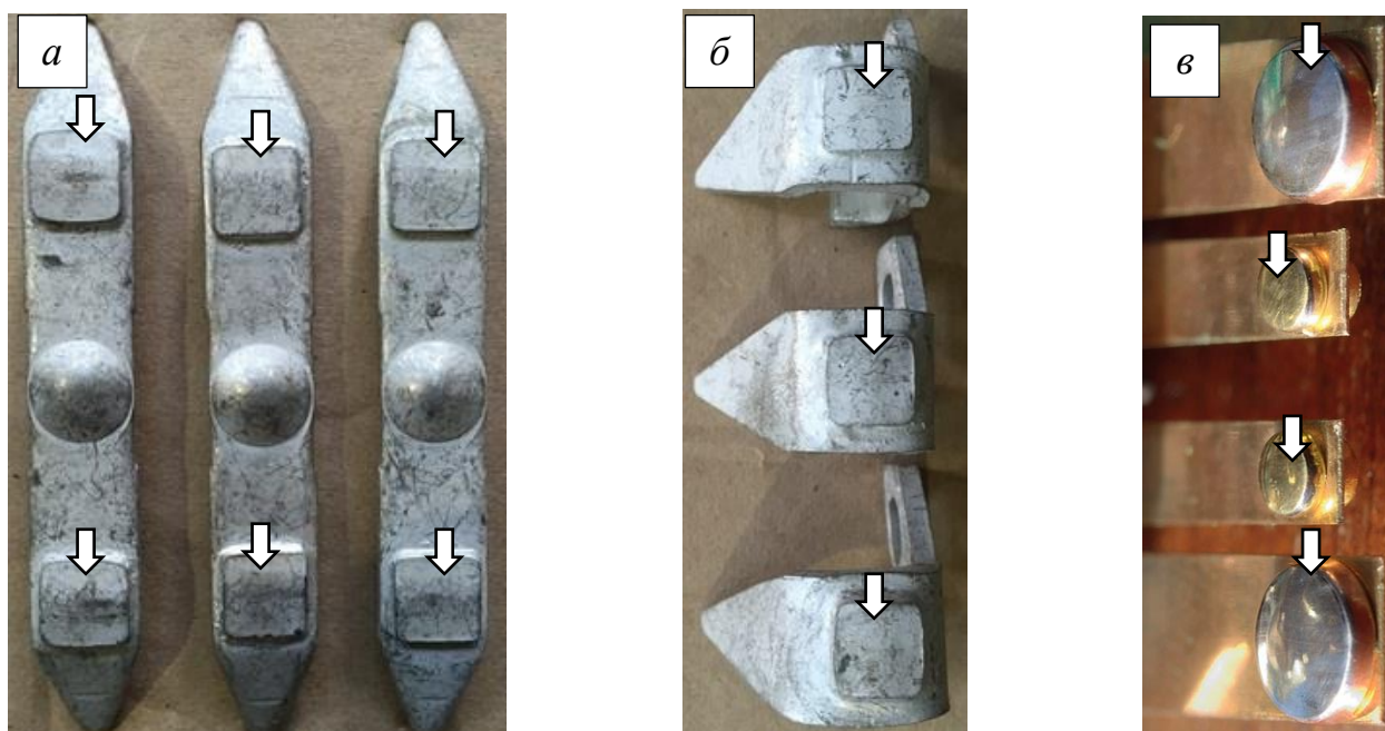
а – контакты, упрочненные покрытиями системы \text{SnO}_2\text{--In}_2\text{O}_3\text{--Ag--N} для контактора EKF 9A 400B, б – контакты, упрочненные покрытиями системы \text{Ag--Ni--N} для магнитного пускателя Texenergo серии КМИ, в – контакты, упрочненные покрытиями системы \text{Ag--C--Ni--N} для реле защиты двигателей [113–116] MPR 20A EKF PROxima
