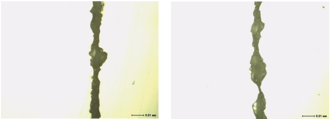
Рисунок 4.22 – Внутренние дефекты в шейке рельсов со скоплениями неметаллических включений
