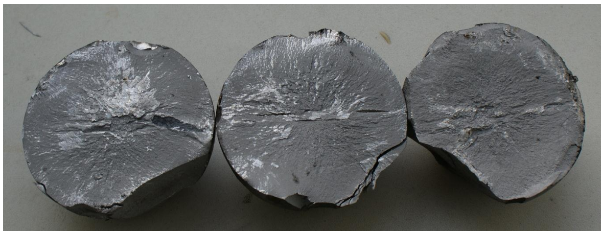
Рисунок 4.29 – Общий вид изломов шаров при испытаниях на ударную стойкость
