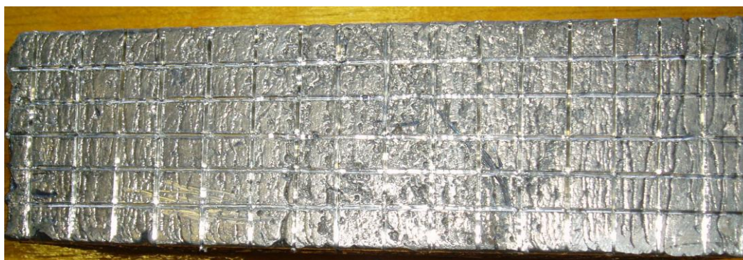
Рисунок 4.3 – Свинцовый образец с координатной сеткой
