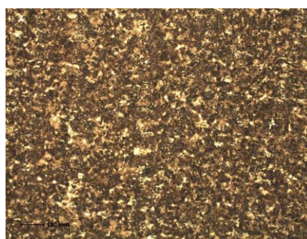
Рисунок 4.32 – Микроструктура образцов рельсовых сталей различного состава
