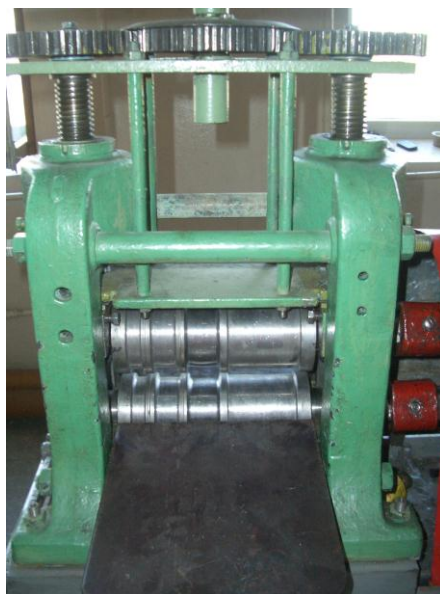
Рисунок 4.2 – Лабораторный прокатный стан «Дуо-80»
