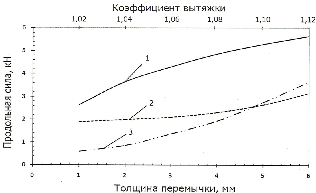
Рисунок 4.6 – Область осуществимости процесса прокатки – разделения для арматуры №12 в условиях непрерывного мелкосортного стана 250-1 АО «ЕВРАЗ ЗСМК»
