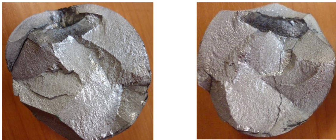
Рисунок 4.9 – Общий вид изломов шаров диаметром 50 мм, прокатанных из заготовок с флокенами
