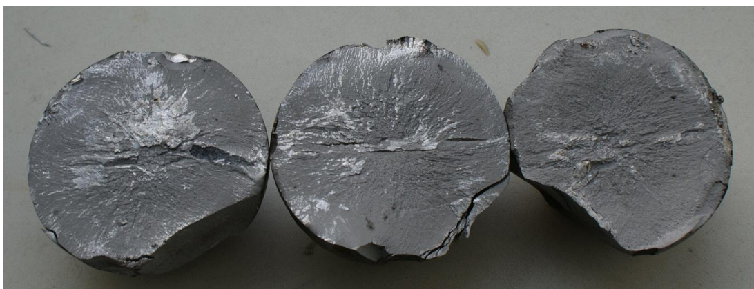
Рисунок 4.6 – Общий вид изломов шаров диаметром 60 мм, прокатанных из заготовок с флокенами
