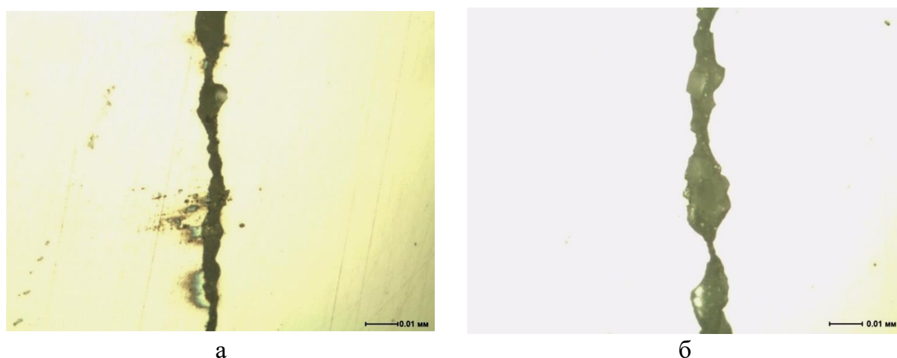
Рисунок 2.7 – Фрагменты расслоения в шейке рельса стали Э76ХФ соответствующие концевым участкам дефекта
