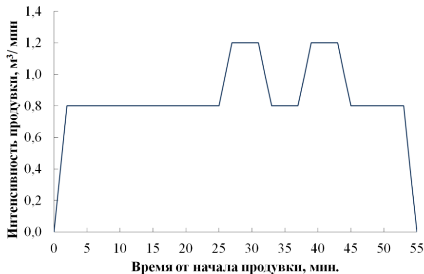
Рисунок 4.2 – Усовершенствованный режим продувки расплава аргоном с одним (а) и двумя (б) периодами повышенной интенсивности вдувания газа
