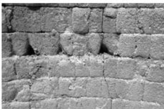
Рисунок 1.2 – Локальный (дырочный) износ периклазоуглеродистой футеровки сталеразливочного ковша
