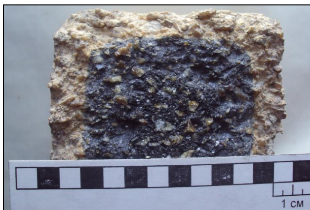
Рисунок 1.1 – Внешний вид обезуглероженного слоя (светлый) в поперечном сечении периклазоуглеродистого огнеупора после первого разогрева перед приемом расплава стали
