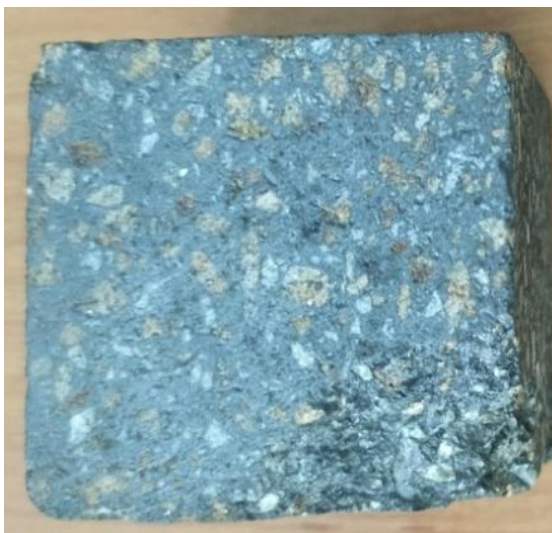
Рисунок 3.14 – Макроструктура образцов огнеупоров марки RI-MC175LC
