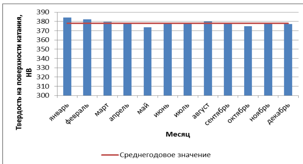
Рисунок 4.4 – Динамика изменения среднемесячных значений твердости на поверхности катания головки рельсов
