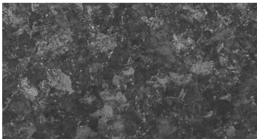
Рисунок 3.22 – Микроструктура образца № 5 рельсовой стали Э76Ф (40 кПа, 845 °С, 105 с), \times 500
