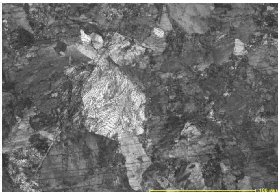
Рисунок 4.7 – Микроструктура металла рельса плавки № 26891 на расстоянии 22 мм от поверхности, ×500
