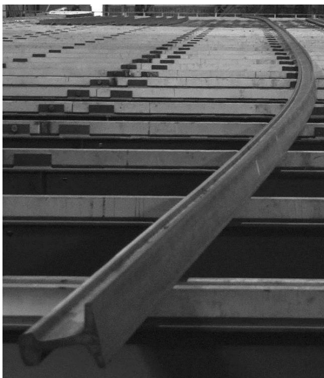
Рисунок 4.1 – Искривление рельсов на холодильнике на начальном этапе промышленного освоения новой технологии термообработки
