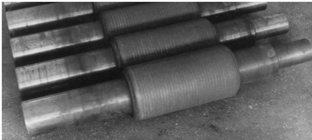
Рисунок 6.11 – Общий вид партии наплавленных валков диаметром 200 мм
