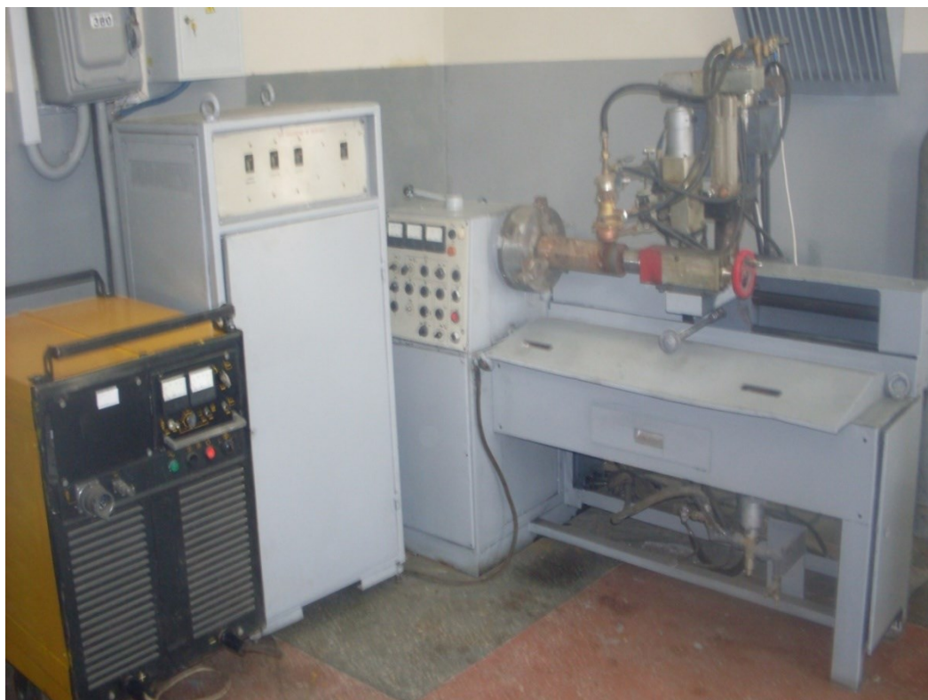
Рисунок 2.3 – Общий вид установки плазменной наплавки порошковыми проволоками УД-417
