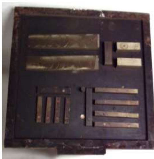
Рисунок 2.1 – Подмодельная плита с моделями для отливки образцов
