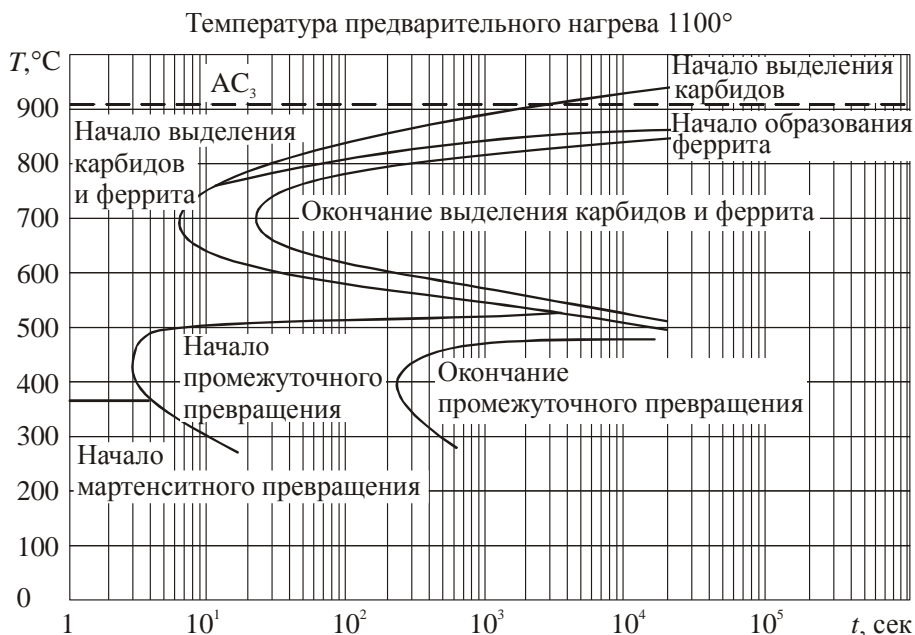
Рисунок 1.12 – Диаграмма изотермического превращения стали с 0,33 % C; 0,24 % Si; 0,17 % Mn и 2,29 % V
