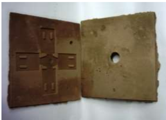
Рисунок 5.2 – Оболочковая форма ножей для гранулятора (Werner & Pfleiderer)
