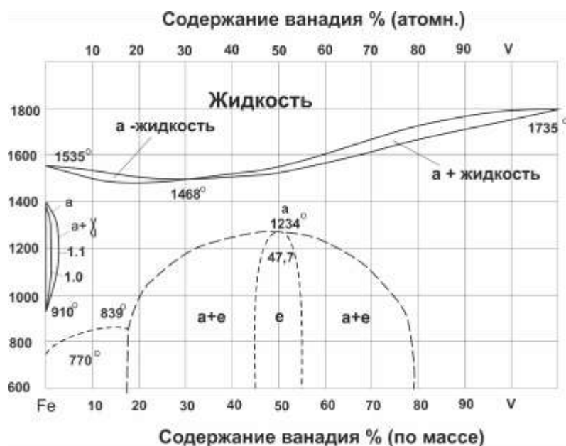
Рисунок 1.9 – Диаграмма состояния сплавов железо-ванадий
