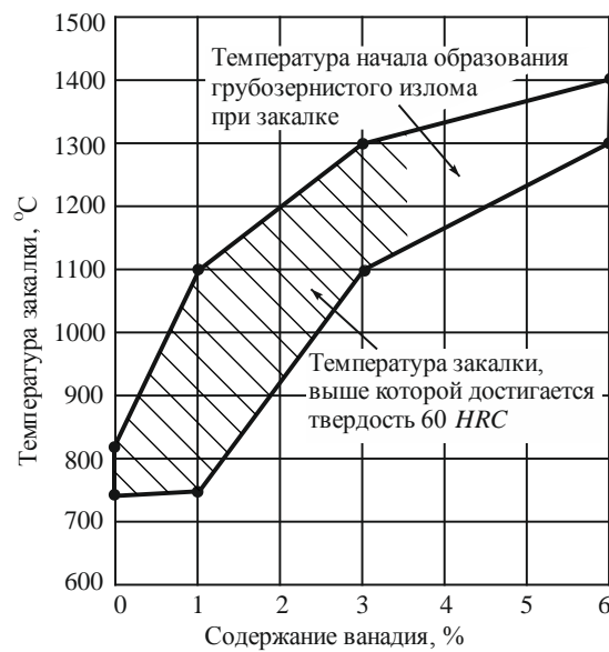
Рисунок 1.16 – Твердость закаленной ванадиевой стали с 1 % С
