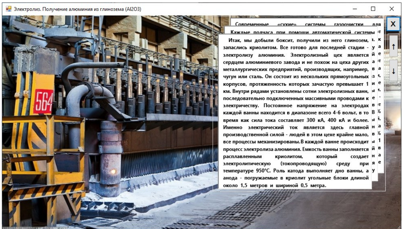
Рисунок 3.11 – Описание выбранного этапа технологического производства
