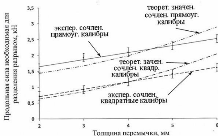
Рисунок 4 – График влияния толщины перемычки и формы сочлененного профиля на продольную силу при разделении разрывом.
