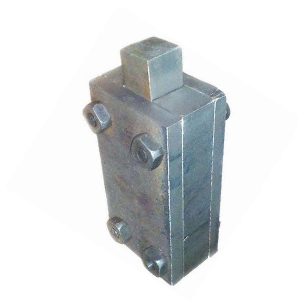
Рисунок 4.8 – Штамповый блок в сборе
